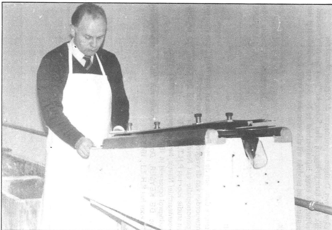
De heer Willy Cleve bij de reinigingsmachine; met dit toestel kunnen duizend haringen per uur gereinigd worden, ontdaan van kop, graten, ingewanden en staart.
